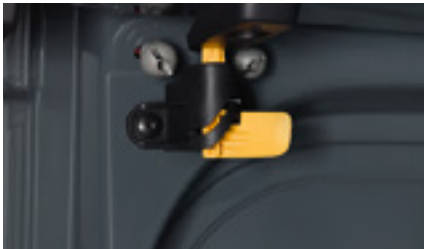
Este inteligente dispositivo te permite bloquear las puertas traseras y dejarlas en posición abierta.
