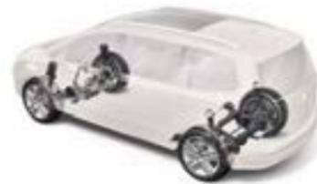
El Control de Chasis Adaptativo DCC regula las válvulas de los amortiguadores para adaptar las características del vehículo a las situaciones de conducción.
