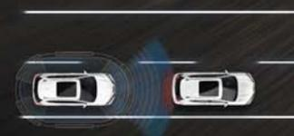
**SISTEMA INTELIGENTE DE ANTI-COLISIÓN FRONTAL CON DETECCIÓN DE PEATONES.** Este sistema controla de forma constante la presencia de objetos o peatones en el camino y evita que colisiones con algo que esté oculto desde la perspectiva del conductor.
