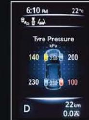
SISTEMA DE CONTROL DE LA PRESIÓN DE LOS NEUMÁTICOS
