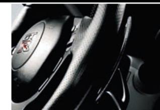
Mandos de transmisión de magnesio montados en la columna de dirección
