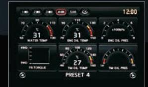
Se han diseñado cinco pantallas de comportamiento personalizables para que el conductor se organice la información esencial según sus gustos personales. Elige entre una variedad de parámetros sobre comportamiento y eficacia del motor, comportamiento en las curvas y fuerza de aceleración y de frenada.
