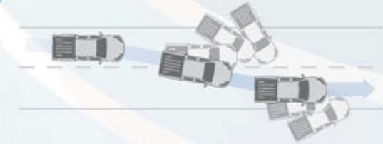
**Control electrónico de diferencial (VDC).** El VDC controla la dirección, la frenada y la estabilidad del vehículo y, cuando es necesario, reduce la potencia y frena de forma individualizada cada rueda para que sigas la trazada deseada.
