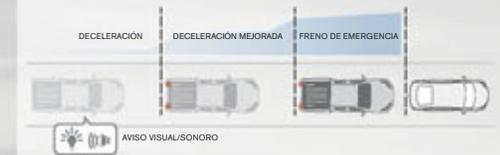
**Sistema anti-colisión frontal (FEB).** El radar en el parachoques delantero mide la distancia que hay con el coche de delante. Si detecta riesgo de colisión emitirá un aviso visual y sonoro. Si no frenas lo suficiente, el vehículo lo hará por ti para evitar el accidente. El sistema funciona a cualquier velocidad y garantiza la frenada sin colisión hasta los 30 km/h.
