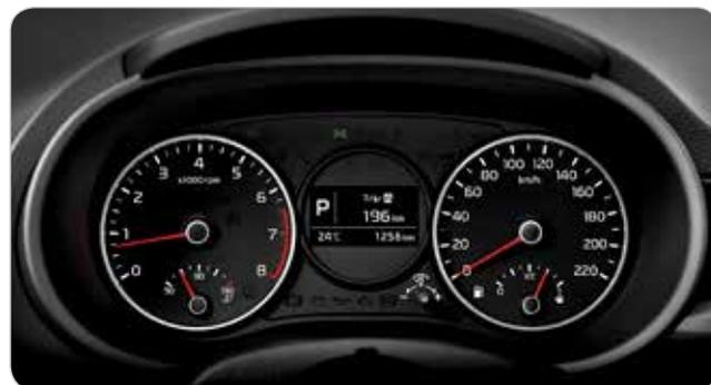
Panel de instrumentos con pantalla LCD de 2,6"
