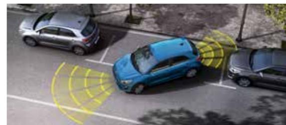
**Sensores de aparcamiento delanteros y traseros** Ideal para aparcar con confianza, el sistema utiliza sensores integrados en los paragolpes delantero y trasero, para advertir de cualquier obstáculo cuando maniobras (equipamiento según versiones).
