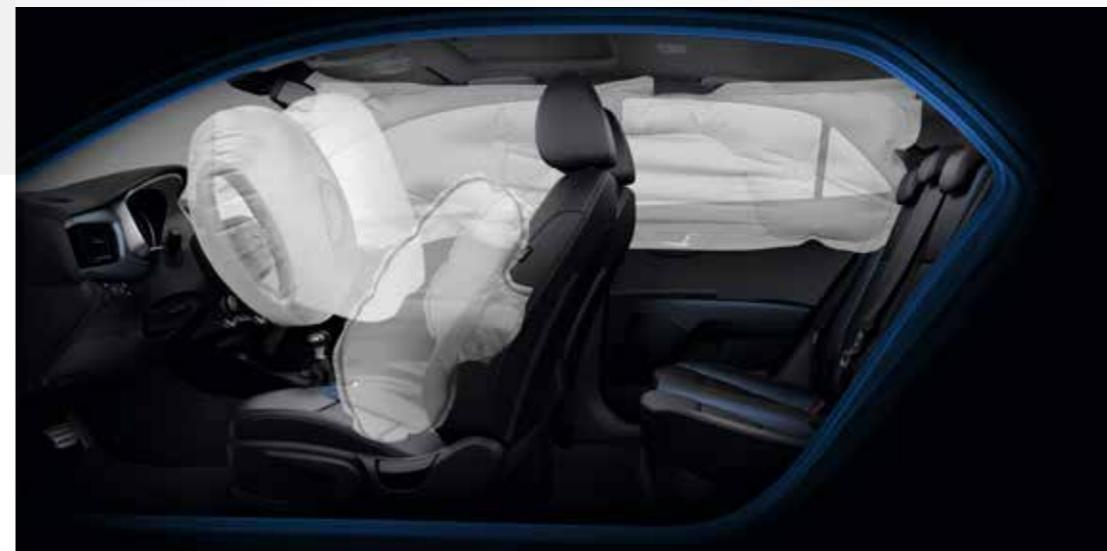
**Seis airbag** El Kia Rio equipa de serie 6 airbag: doble airbag frontal, airbag laterales delanteros y de cortina.
