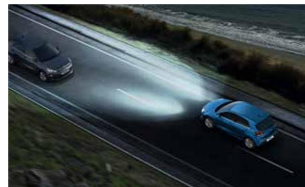
**Asistente dinámico para luces de carretera** La cámara integrada en el parabrisas detecta los vehículos que vienen en dirección contraria por la noche y cambia automáticamente a una luz de cruce para evitar deslumbrar a los demás conductores (equipamiento según versiones).
