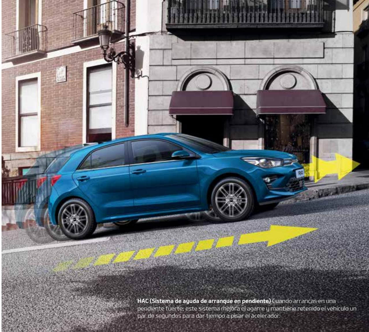
**HAC (Sistema de ayuda de arranque en pendiente)** Cuando arrancas en una pendiente fuerte, este sistema mejora el agarre y mantiene retenido el vehículo un par de segundos para dar tiempo a pisar el acelerador.
