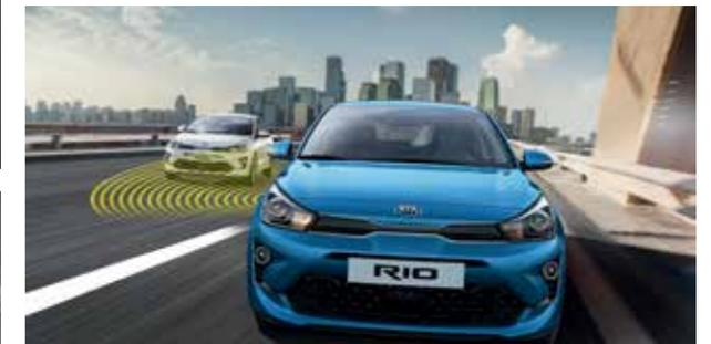
**Sistema de detección de ángulo muerto (BCW)** Cuando quieres cambiar de carril, el sistema detecta cualquier vehículo en el punto muerto y te avisa con un símbolo de advertencia en el espejo lateral y en la pantalla, además de una señal acústica (equipamiento según versiones).
