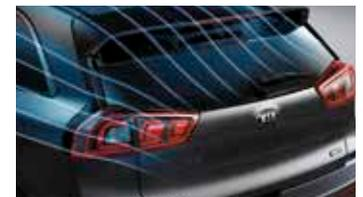
**Alerón trasero** Aprovecha el flujo de aire para ayudar a estabilizar la carrocería en los desplazamientos a alta velocidad.
