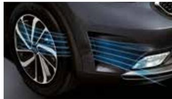
**Cortina de aire** Esta cortina crea un flujo de aire en la parte delantera, reduciendo la resistencia provocada por el mismo y mejorando la aerodinámica del vehículo.
