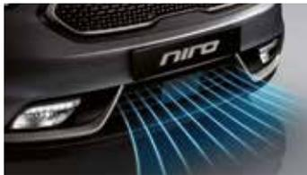
**Salida de aire** Creado para refrigerar el motor, se cierra a velocidades elevadas para reducir la resistencia aerodinámica y mejorar el rendimiento y el ahorro de combustible.
