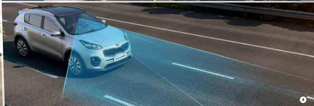
1. El opcional **Sistema de asistencia de frenada de emergencia** es capaz de detectar tanto al vehículo que va por delante como a los peatones que crucen la calzada. Utiliza sensores y una cámara que controla la proximidad y la velocidad de los vehículos, para avisar al conductor si se detecta una posible colisión. Si el conductor no reacciona, el coche frena automáticamente, evitando o atenuando cualquier accidente, siempre y cuando se cumplan unas determinadas premisas.
