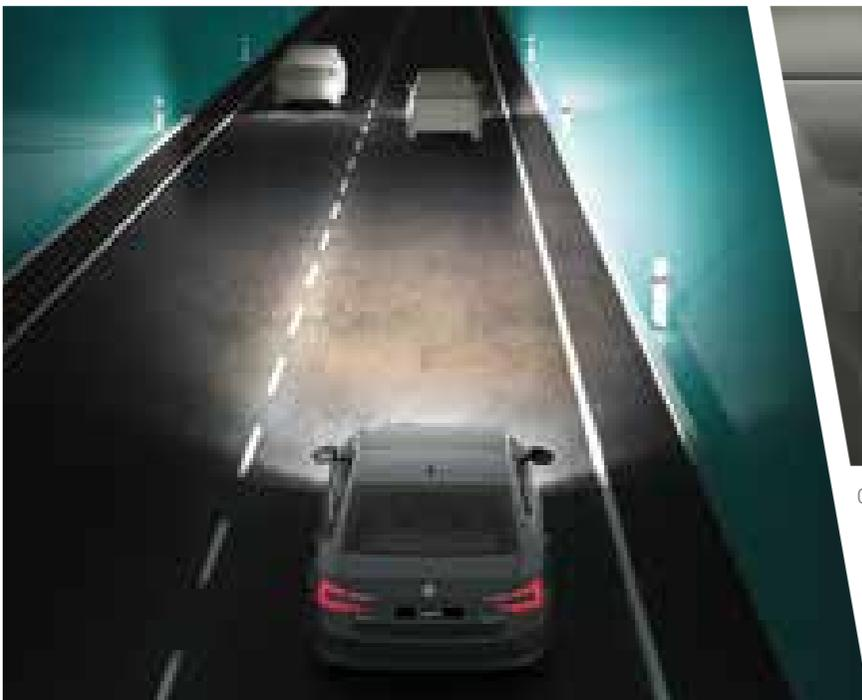
Ahora puedes utilizar las luces de carretera durante más tiempo sin deslumbrar a los conductores en sentido contrario. El Smart Light Assistant (Asistente de luz inteligente) no sólo puede cambiar las luces, sino también atenuar las luces de carretera utilizando una cámara multifuncional situada en el espejo del retrovisor interior.
