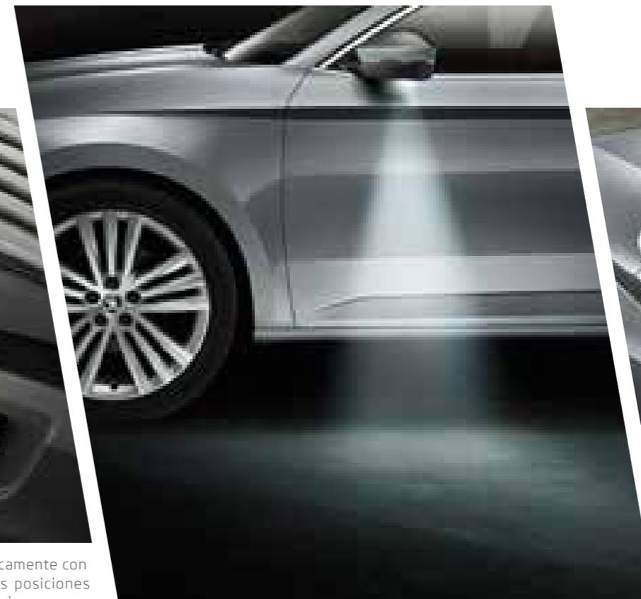
Las Luces Boarding Spot (zona de embarque), diseñadas para iluminar el área de entrada, se encuentran en los retrovisores exteriores y en la parte inferior de las puertas delanteras y traseras. Te ayudarán, por ejemplo, a evitar los charcos en la oscuridad.
