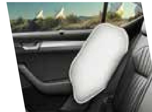
Los airbags laterales delanteros y traseros protegen la pelvis y el pecho del conductor y demás pasajeros en caso de colisión lateral.
