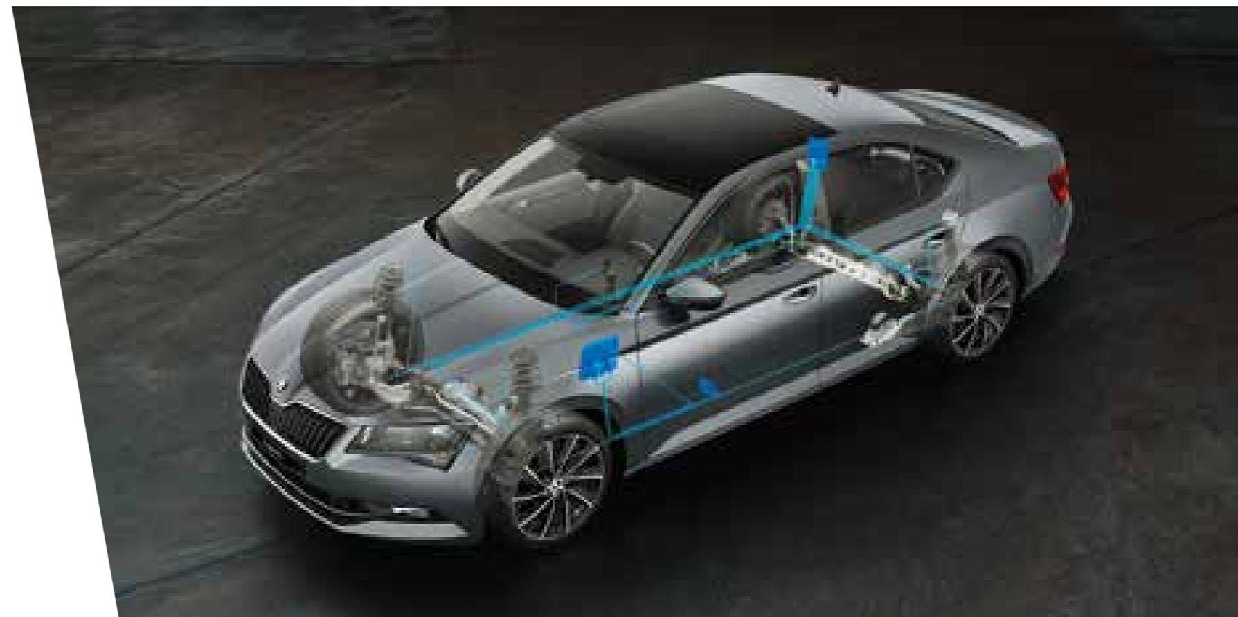
Disfruta de las altas prestaciones de tu coche con el máximo confort y seguridad. El Dynamic Chassis Control (Control dinámico del chasis) (DCC) evalúa de forma continua y responde a distintas situaciones de conducción (frenado, aceleración, giro), adaptando las características de la amortiguación y la dirección. Como parte del menú de infotainment, te permite seleccionar uno de los cuatro modos, Normal, Confort, Ecológico o Sport (opcional) en función de tus necesidades específicas.
