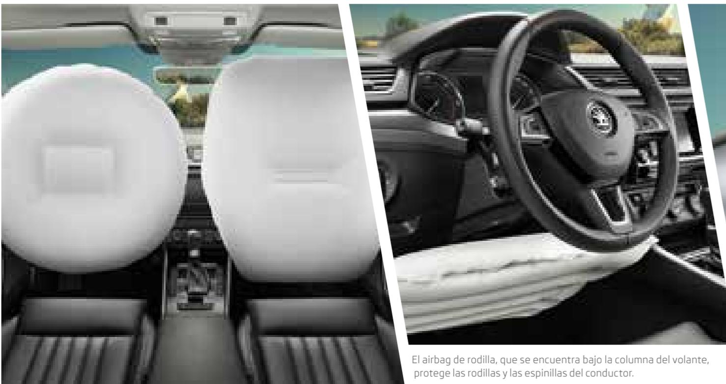
El airbag de rodilla, que se encuentra bajo la columna del volante, protege las rodillas y las espinillas del conductor.
