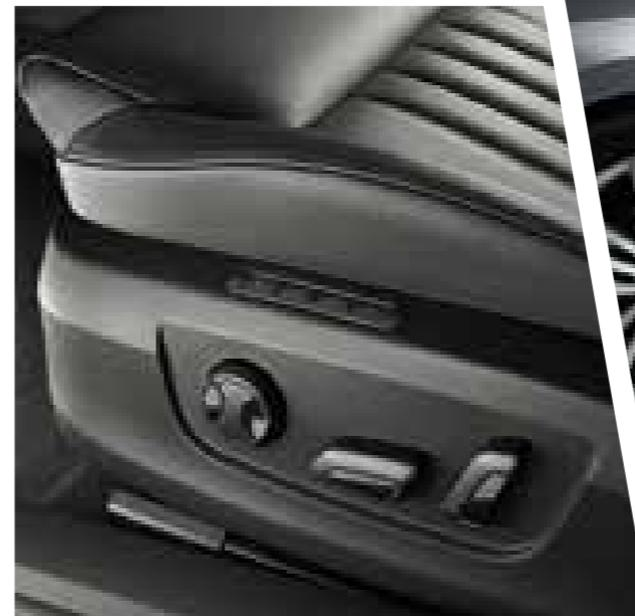
El asiento del conductor regulable electrónicamente con función de memoria puede almacenar tres posiciones distintas para el asiento y los retrovisores exteriores.
