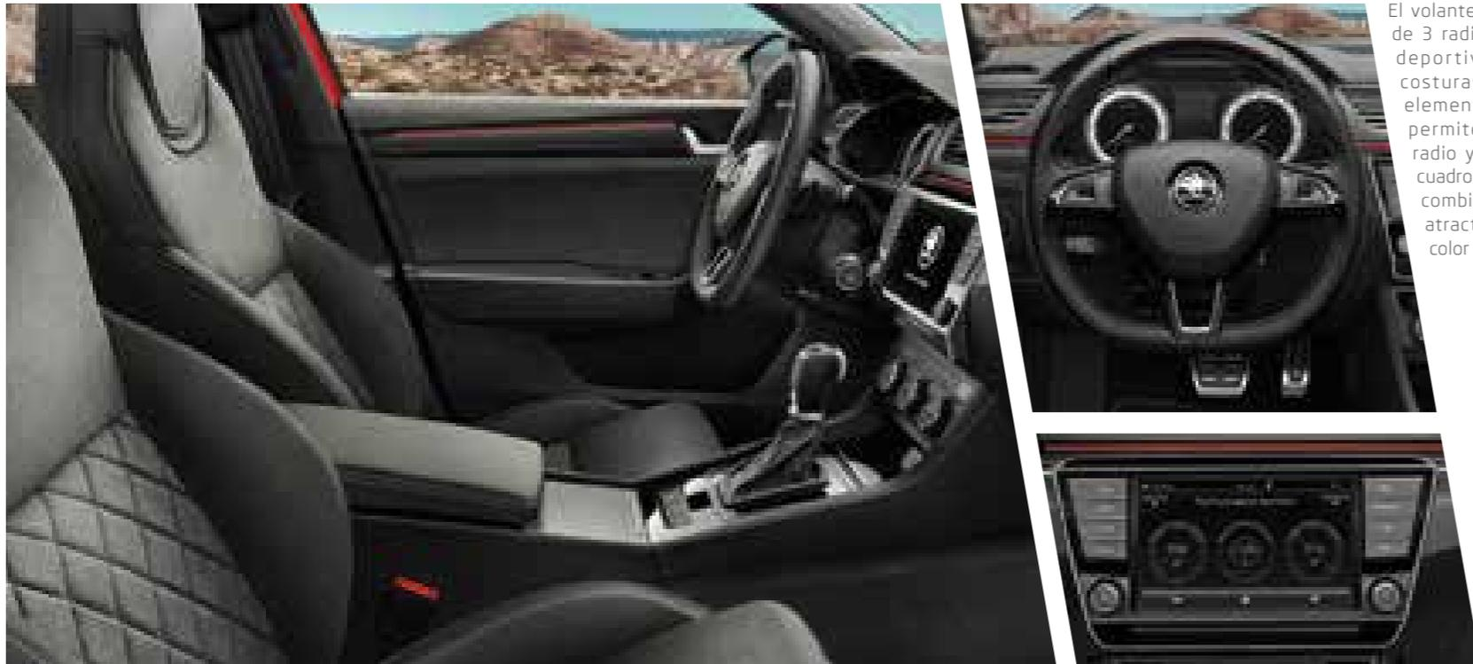
El volante multifuncional de 3 radios, con diseño deportivo de cuero, costuras plateadas y elementos de cromo, permite controlar la radio y el teléfono. El cuadro de instrumentos combinado incluye la atractiva pantalla en color Maxi DOT.
